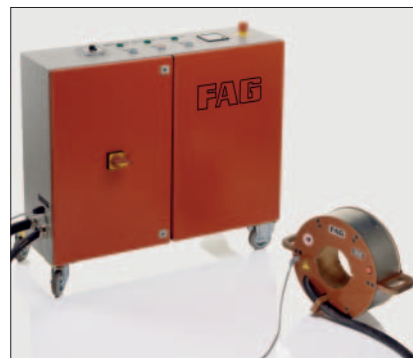
Щит управления электроиндукционного устройства сетевого напряжения для демонтажа внутренних колец цилиндрических роликовых подшипников
