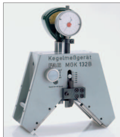
Измерительный прибор для конических поверхностей FAG MGK 132
