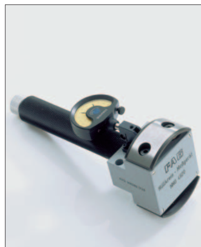
Измерительный прибор FAG MGI 21 для регулирования радиального зазора или предварительного натяга цилиндрических роликоподшипников со съемными внутренними кольцами
